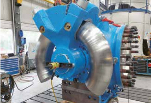
Nos Ateliers centraux, à Martigny, ont procédé à la révision complète de trois vannes sphériques critiques, n°4 (à entraînement mécanique), n°6 (DN 700) et ici la n°8 (DN 1000), avec le montage du piston torique.
