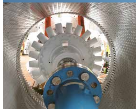
Au terme de la révision de l'alternateur, le rotor est réintroduit dans le stator.
