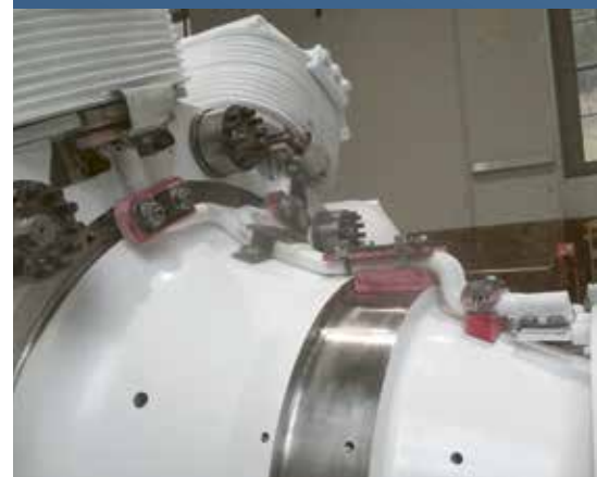
Die Verbindungen zwischen den Ringen und den Polen wurden komplett erneuert.
