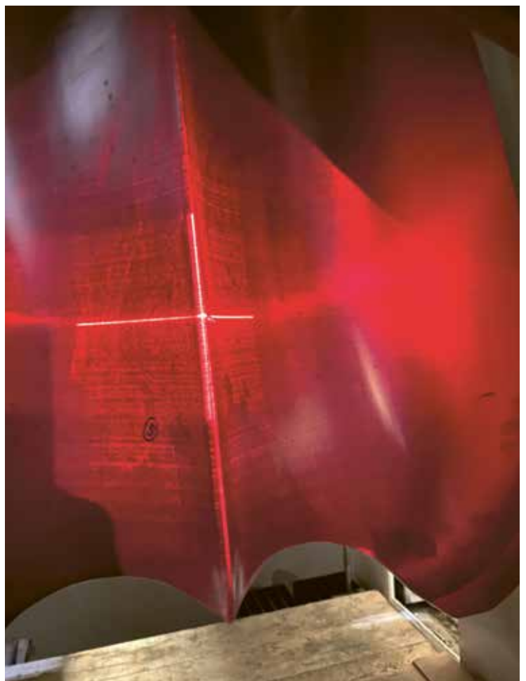
Der Laserpointer erlaubt den Aufprallpunkt des Wassers auf dem Peltonrad zu überprüfen.
