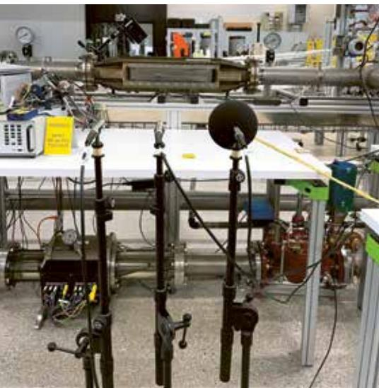
Cavision: essais dans le laboratoire de la HES-SO Valais-Wallis du module de détection de la cavitation.
