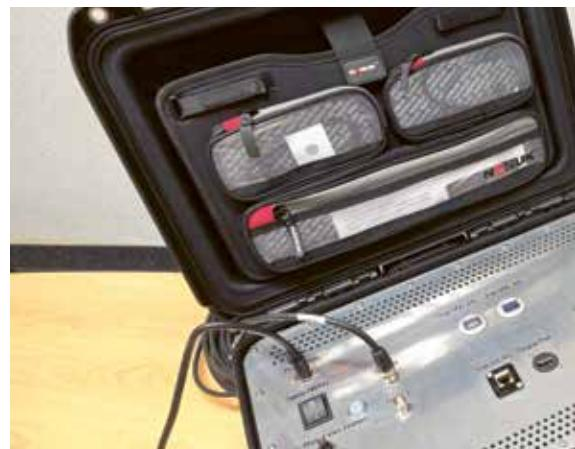
Cavision: version pré-industrielle du module de détection de la cavitation.
