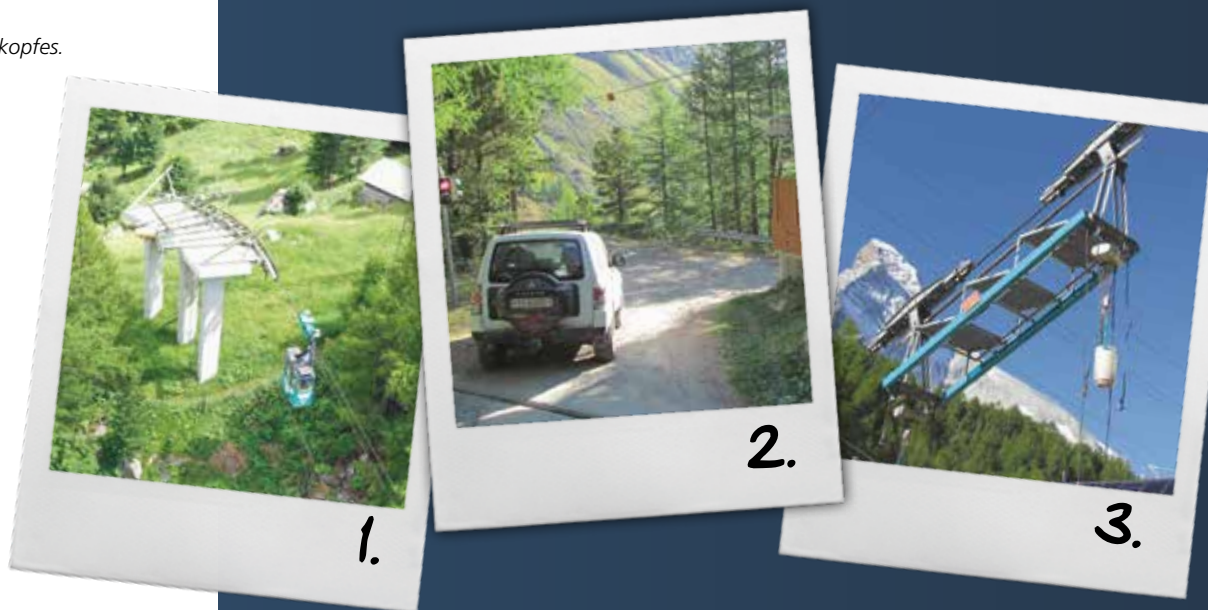
Kurvenst tze mit 31  Ablenkung. Mit zwei Kurvenst tzen ist diese Seilbahn eine Seltenheit in Europa.
