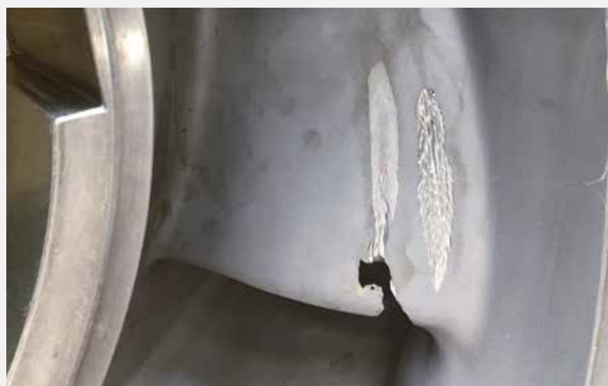
Lors du turbinage ou du pompage, des poches de vapeur se créent, qui implosent brutalement, provoquant vibrations, érosion, etc. Le projet CaVision vise à repérer ce phénomène, la cavitation, pour en minimiser les conséquences.
