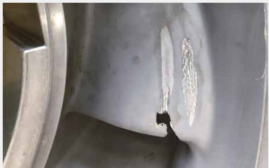
Beim Turbinieren oder Pumpen entstehen Dampfblasen, die plötzlich implodieren und dadurch u. a. Vibrationen und Erosion verursachen. Das Projekt CaVision zielt darauf ab, dieses unter dem Namen Kavitation bekannte Phänomen zu identifizieren und seine Folgen zu minimieren.
